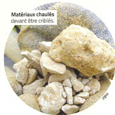
Matériaux bruts à traiter à la chaux.
